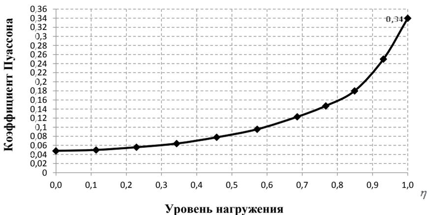
**Рисунок 7.** Корреляционная зависимость «уровень нагружения – коэффициент Пуассона» для образцов из бетона класса LC30/33 в возрасте 21 суток
