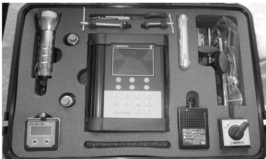
Рисунок 2.3 – Схема оборудования для уравновешивания ротора
