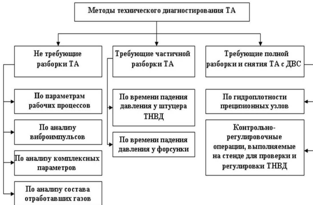
Рис. 2.1 – Методы технического диагностирования ТА дизельных ДВС
