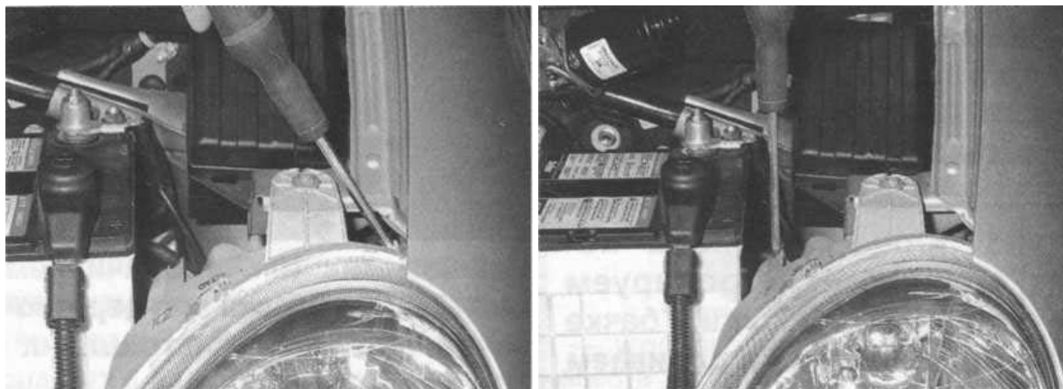
Рисунок 4.5 – Места расположения регулировочных винтов световых приборов автомобиля Daewoo Matiz
