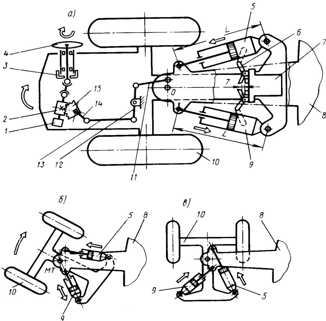
*a* – общая схема (начало поворота направо); *б* – прохождение гидроцилиндром 9 положения мертвой точки; *в* – поворот тягача на  $90^\circ$  направо; 1 – рулевой механизм; 2 – червяк; 3 – гайка; 4 – колесо рулевое; 5, 9 – гидроцилиндры; 6 – механизм рычажный; 7 – коробка золотниковая; 8 – рама упряжная; 10 – рама тягача; 11, 13 – тяги; 12 – рычаг; 14 – сошка; 15 – сектор
