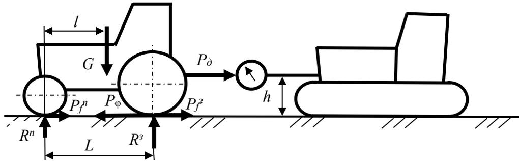
Рисунок 4.1 – Нагружение испытуемой машины
