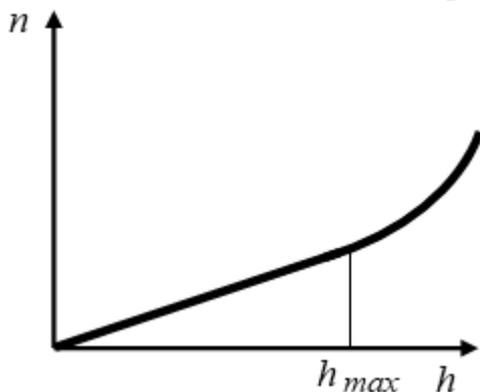
Рисунок 12.2 – Зависимость числа повторений приложения нагрузки от толщины уплотняемого слоя
