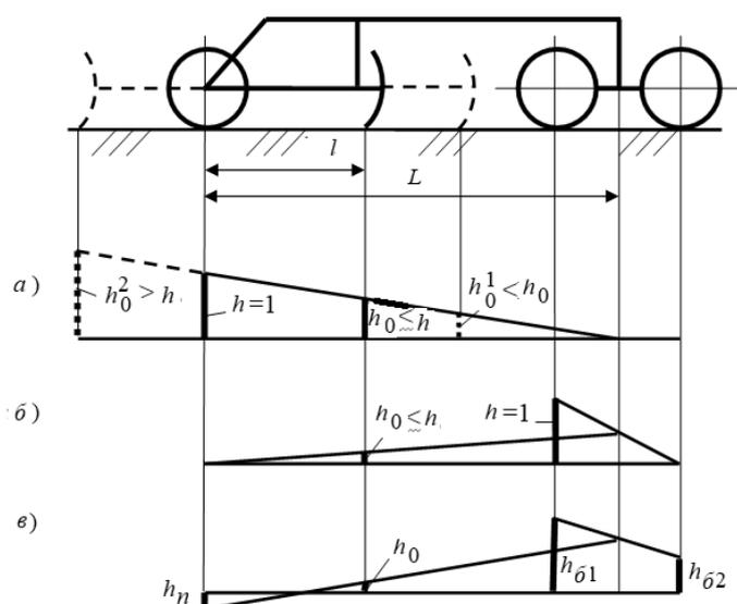
*a* – наезд передних колес на препятствие единичной высоты; *б* – наезд передних колес балансира на такое же препятствие; *в* – наезд всех колес одновременно на препятствия разной высоты
