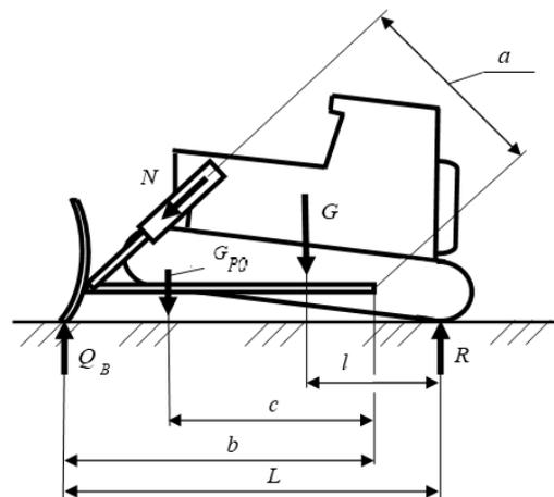
Рисунок 6.2 – Расчетная схема для определения максимального заглубляющего усилия
