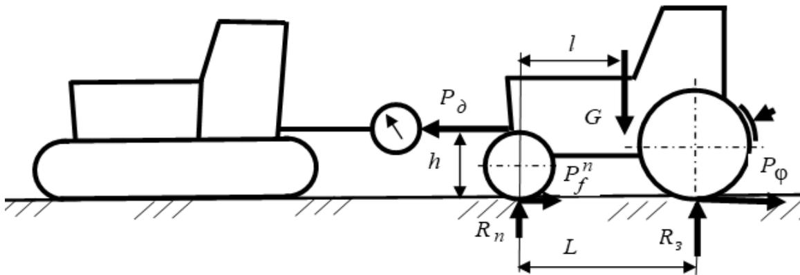
Рисунок 4.2 – Буксировка испытуемой машины с затянутыми тормозами
