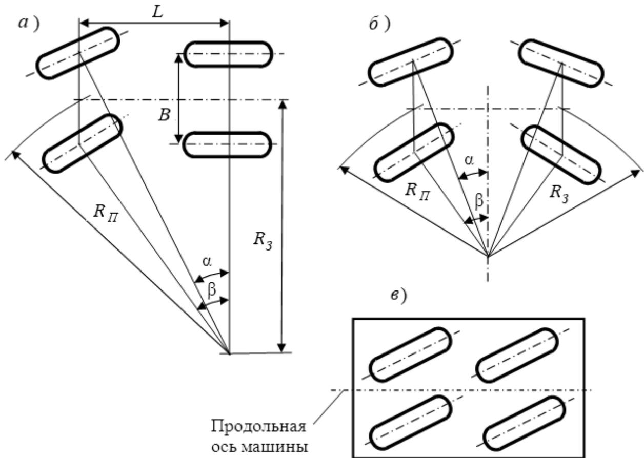
$a$  – с двумя управляемыми колесами;  $b$  – со всеми управляемыми колесами с их поворотом в разные стороны;  $c$  – со всеми управляемыми колесами с их поворотом в одну сторону
