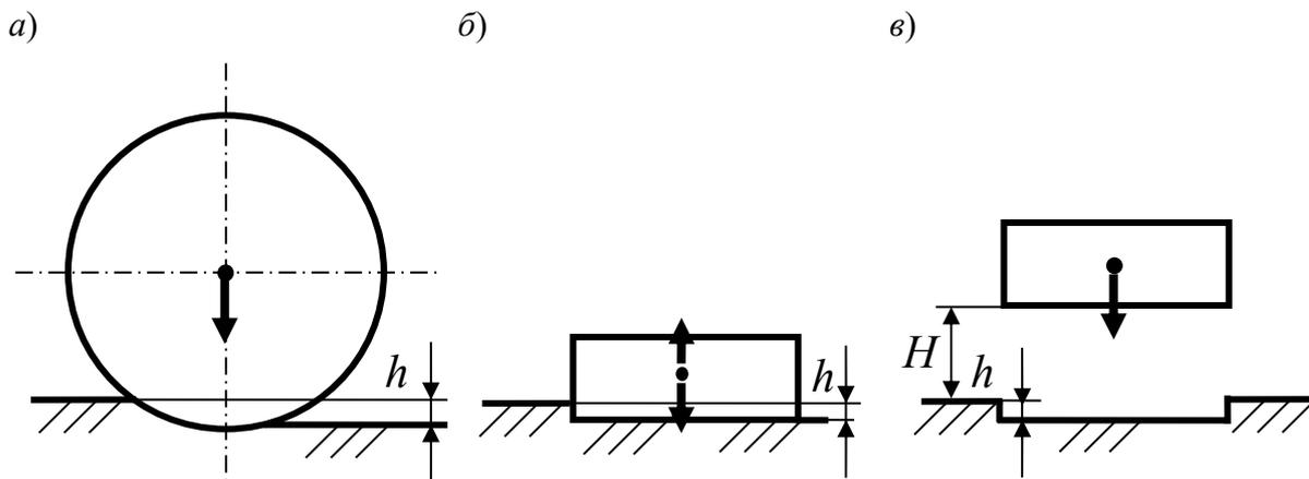
*a* – укаткой; *б* – виброуплотнением; *в* – трамбованием
