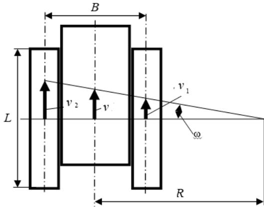
Рисунок 8.1 — Схема поворота гусеничной машины
