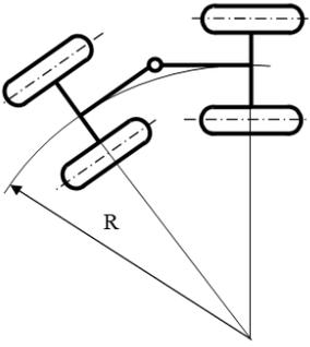
Рисунок 8.4 – Схема поворота машины с шарнирно-сочлененной рамой
