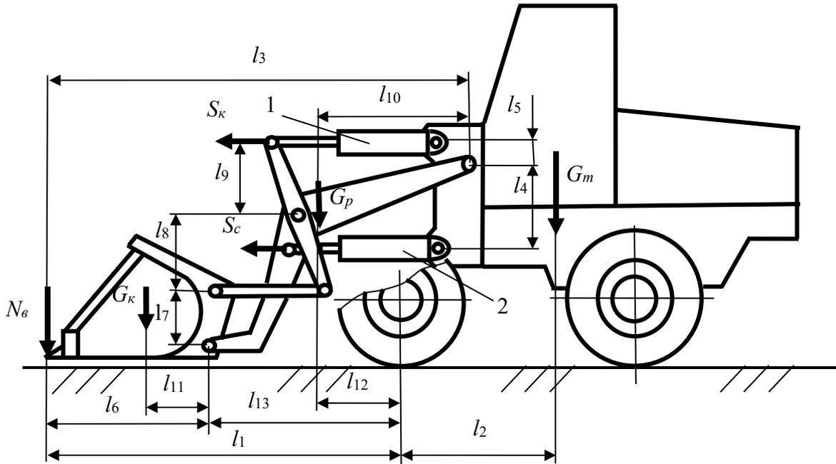
Рисунок 5.1 – Схема определения усилий на режущей кромке ковша и гидроцилиндрах погрузчика
