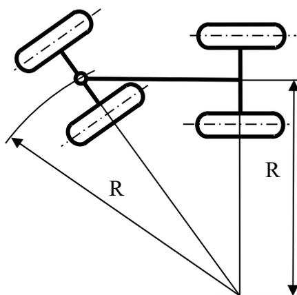
Рисунок 8.6 – Схема поворота машин изменением положения управляемой оси
