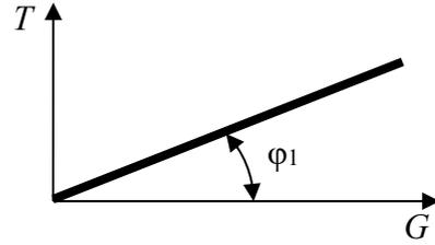
Рисунок 1.1 – Схема к определению угла внешнего трения (а) и ее графическая интерпретация (б)
