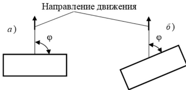
Рисунок 9.2 – Лобовое (а) и косое (б) резание грунта
