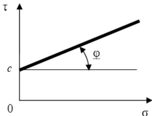
Рисунок 1.2 – Зависимость касательных напряжений от нормальных при сдвиге грунта
