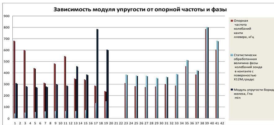
Рис. 1. Зависимость модулей упругости слоев и подложки от опорной частоты и фазы
