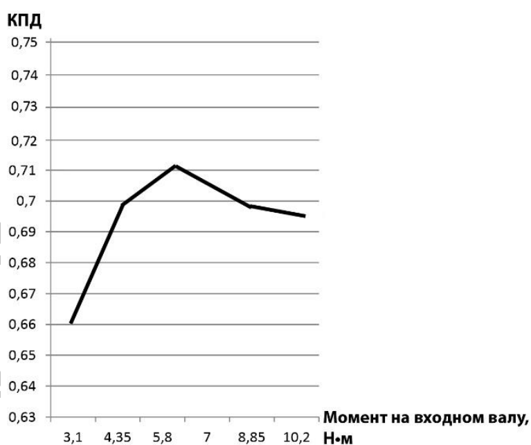
Рис. 2. Зависимость КПД редуктора от момента на выходном валу, материал венца колеса – чугун СЧ 30
