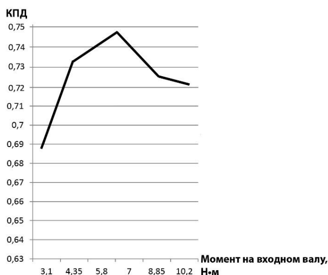
Рис. 1. Зависимость КПД усовершенствованного редуктора от момента на выходном валу, материал венца колеса – сталь 40ХЛ
