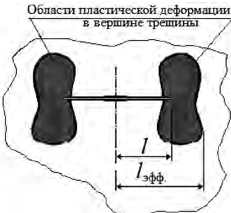
Рис. 2. К определению эффективной длины трещины
