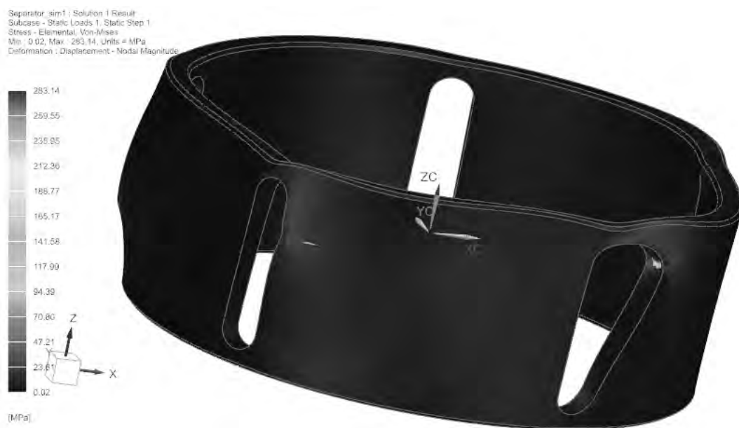
Рис. 5. Распределение напряжений в сепараторе
