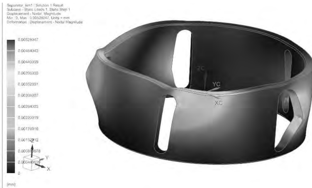
Рис. 4. Распределение деформаций в сепараторе
