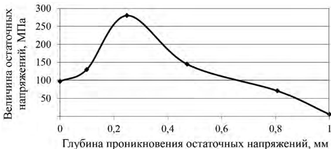
Рис. 5. Распределение остаточных напряжений по глубине материала под местом нанесения удара: материал деформирующего шара – ШХ15; материал заготовки – высокопрочный чугун; диаметр шара – 10 мм; скорость шара – 1,5 м/с
