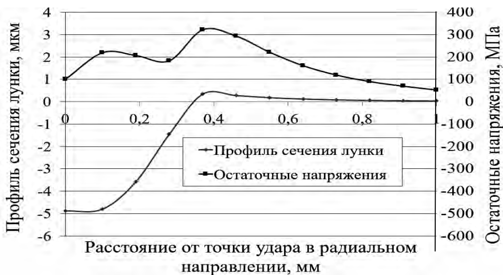
Рис. 7. Зависимость расположения остаточных напряжений на обрабатываемой поверхности по мере удаления от точки удара, наложенная на полупрофиль лунки
