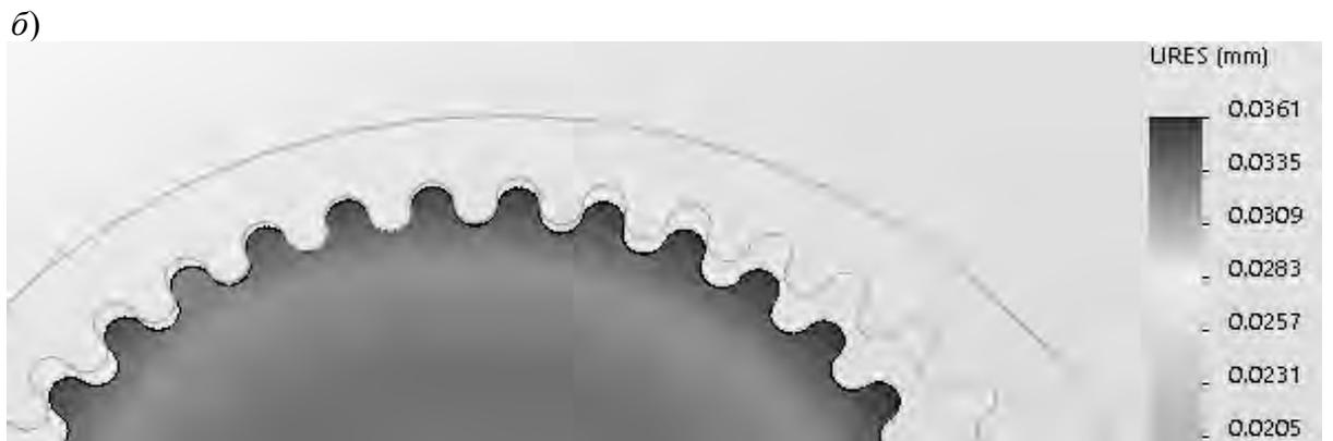
Рис. 5. Результаты компьютерного моделирования передачи с круговым профилем зубьев: *a* – передача без механизма выравнивания распределения нагрузки; *б* – передача с предложенным механизмом выравнивания распределения нагрузки
