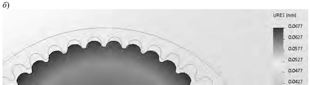
Рис. 4. Результаты компьютерного моделирования передачи с циклоидальным профилем зубьев: *a* – передача без механизма выравнивания распределения нагрузки; *б* – передача с предложенным механизмом выравнивания распределения нагрузки
