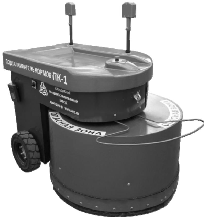
Рис. 5. Типовая конструкция МАТС с АЭП и МПСУ, применяемая на предприятиях сельского хозяйства по производству молока, для взрослых особей
