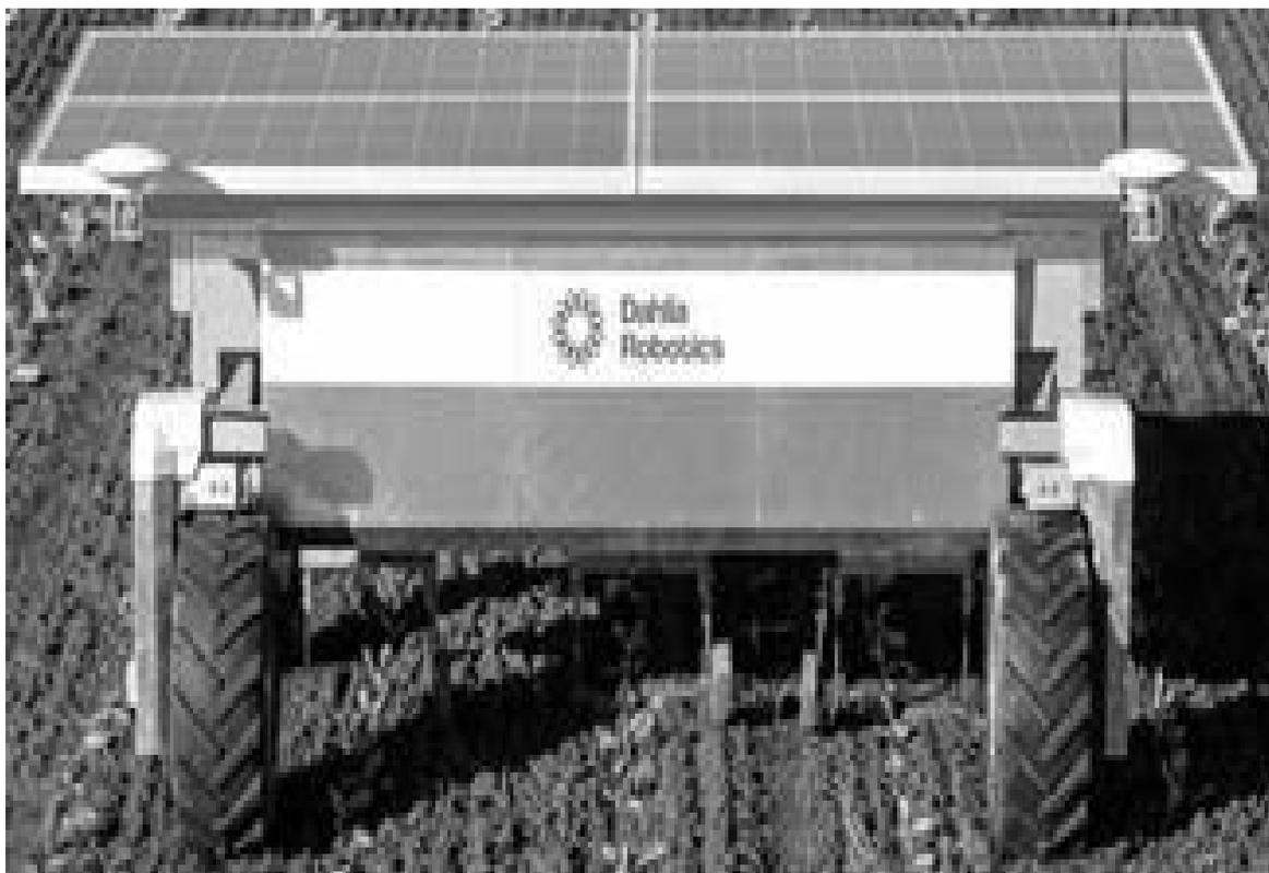
Рис. 7. Типовая конструкция МАТС с АЭП и МПСУ, применяемая на сельскохозяйственных лугах/полях
