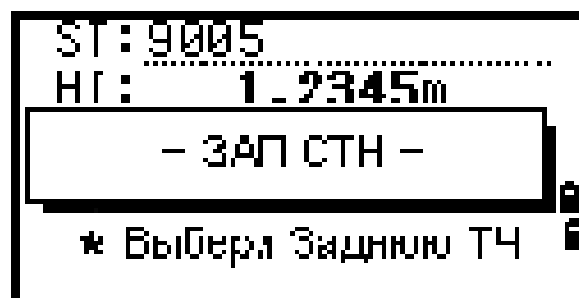
Рисунок 8.18 – Экран с записью установки станции
