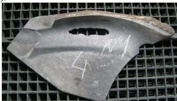
Рис. 1. Изношенная деталь «подкладной лист»
