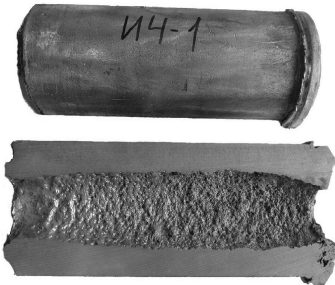
Рис. 1. Полая цилиндрическая отливка из антифрикционного силумина, полученная методом непрерывно-циклического литья намораживанием
