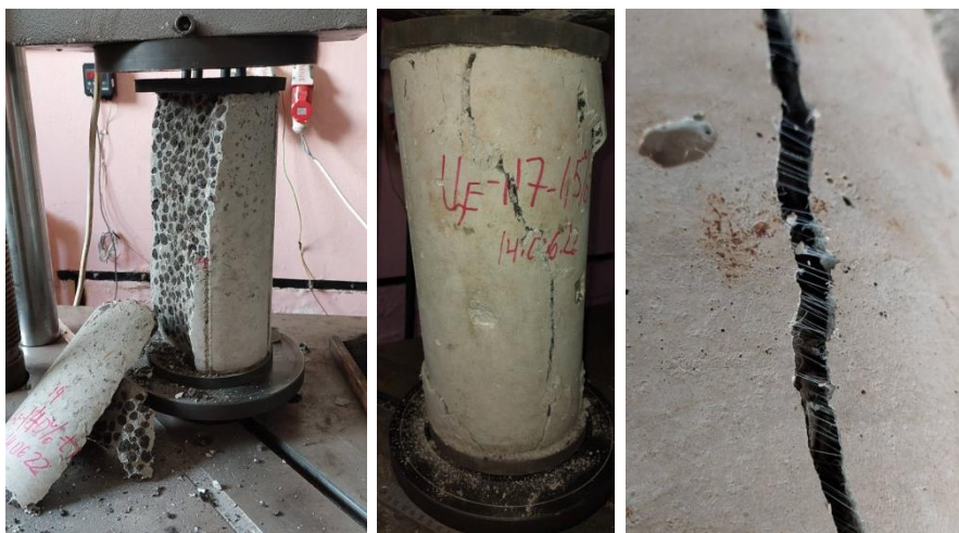
слева – неармированный керамзитобетонный цилиндр, в центре – керамзитоволокнобетонный цилиндр; справа – положение фибровых волокон в пределах раскрытия трещины Рисунок 1 – Опытные цилиндры после испытаний осевой кратковременной нагрузкой до разрушения
