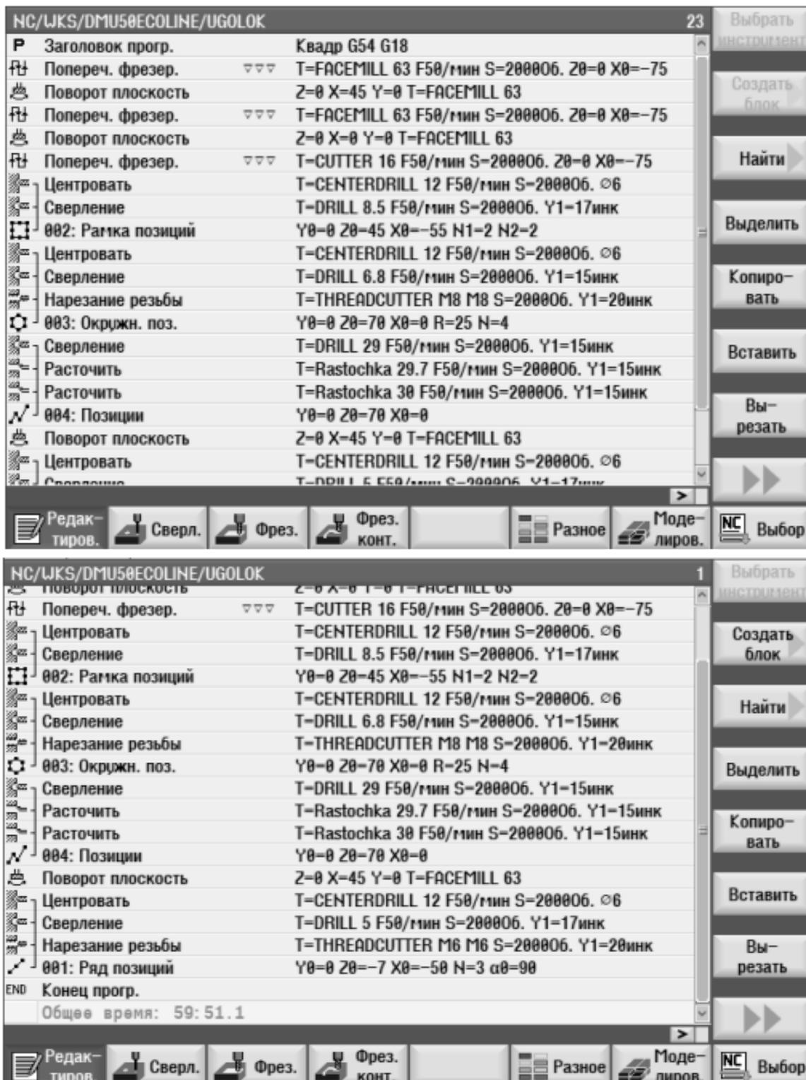
Рисунок 8.12 – Вид управляющей программы изготовления детали
