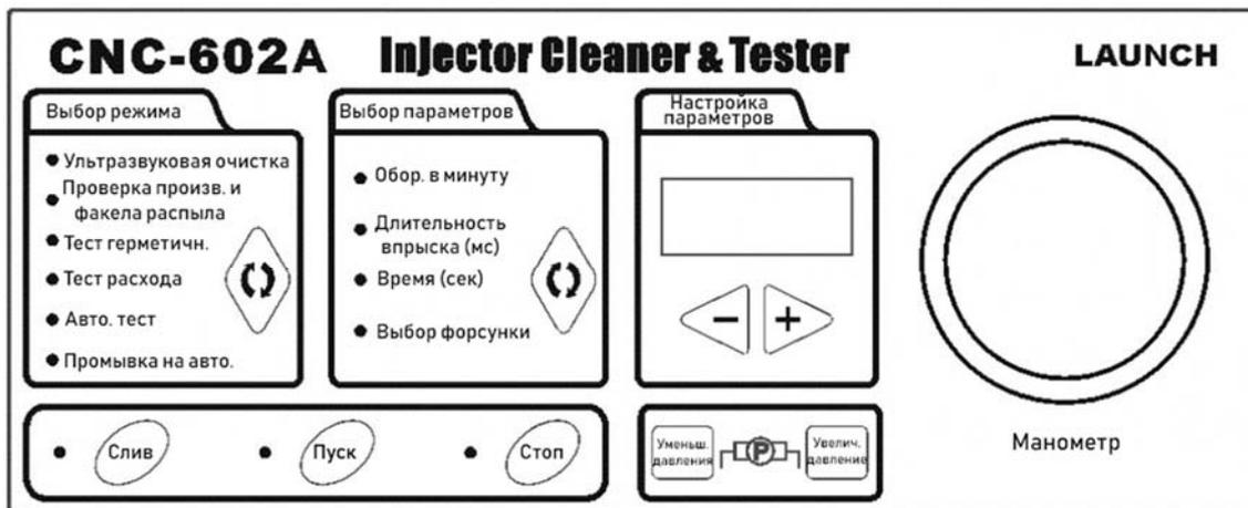
Рисунок 10.2 – Панель управления прибором CNC-602
