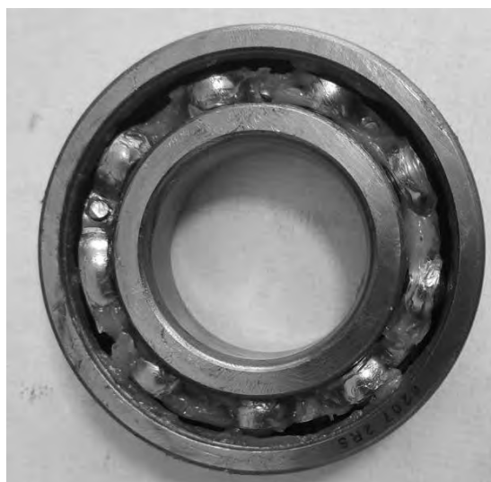
Рис. 2. Нанесенные дефекты на подшипники качения: а – лунка на дорожке качения наружного кольца; б – сломанное звено сепаратора
