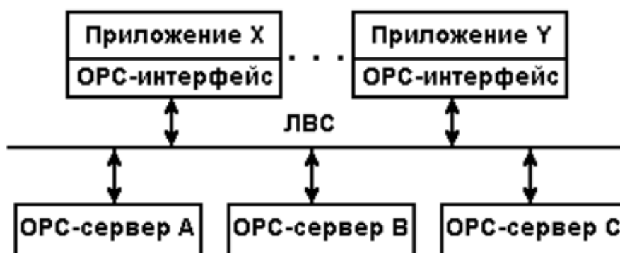
Рисунок 3.6 – Схема взаимодействия управляющих устройств при использовании стандарта OPC
