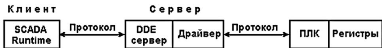
Рисунок 3.4 – Обмен информацией с помощью DDE-протокола
