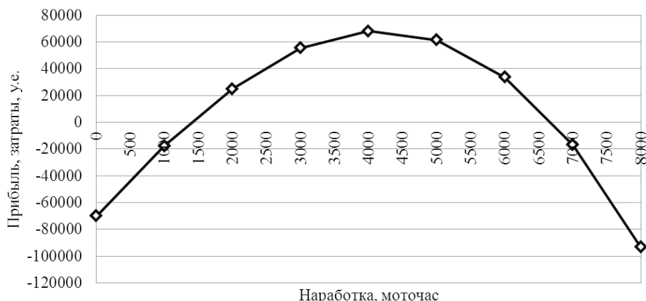
Рисунок 5. – Суммарная прибыль, получаемая при эксплуатации погрузчика в зависимости от наработки с начала эксплуатации
