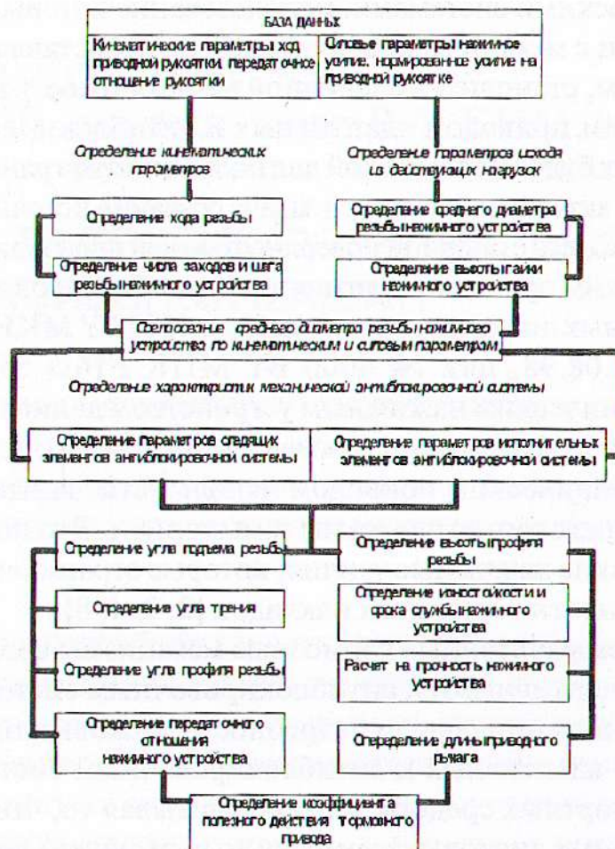
Рисунок 1 — Алгоритм расчета параметров дискового тормоза с механическим приводом адаптивного к механической антиблокировочной системе
