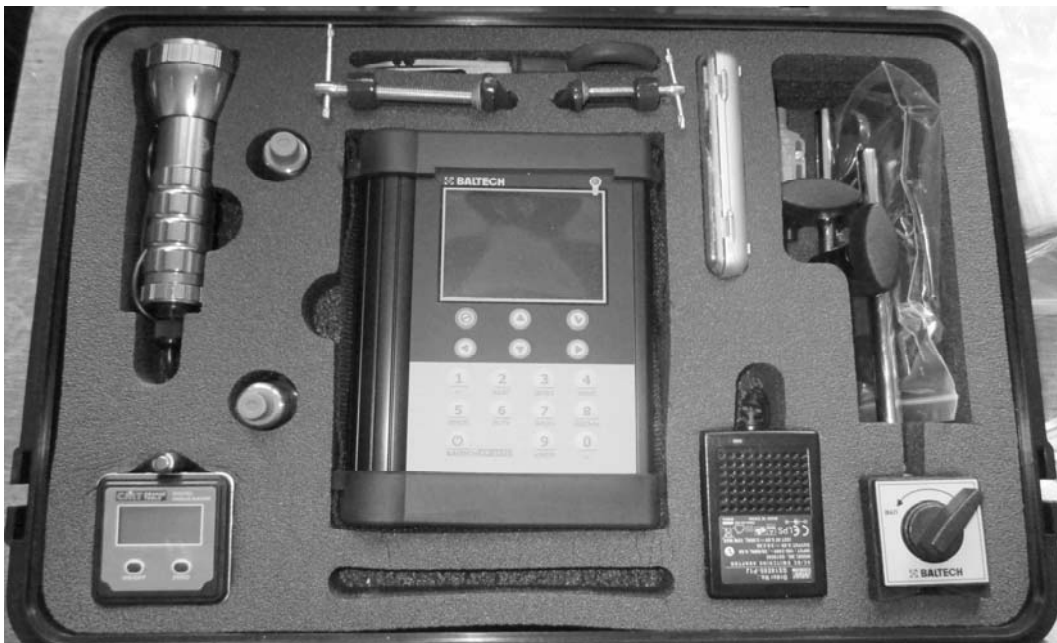
Рисунок 2.3 – Схема оборудования для уравнивания ротора
