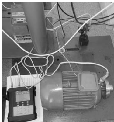
Рисунок 2.4 – Стенд для одноплоскостного уравнивания ротора
