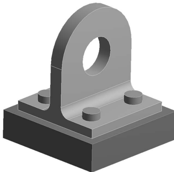
Рисунок 13.1 – Болтовое соединение проушины и основания
