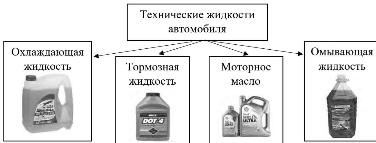
Рис. 1. Используемые в автомобиле технические жидкости
