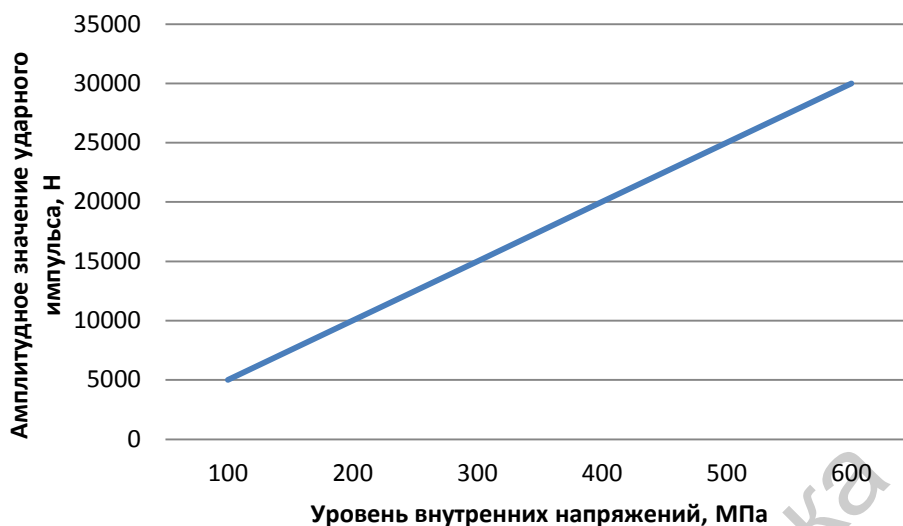
Рис. 1. График зависимости уровня внутренних напряжений детали от амплитудных значений ударного импульса
