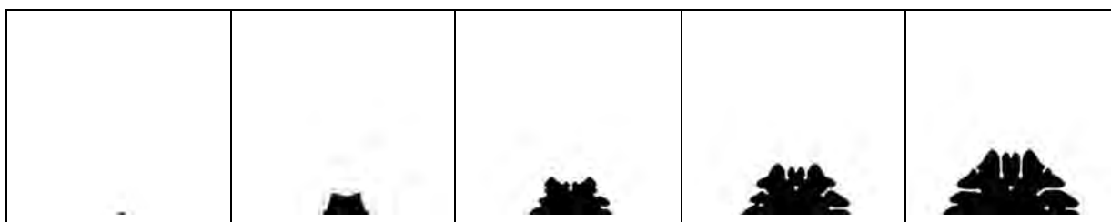
Рис. 3. Половина растущего кристалла с изменением во времени степени переохлаждения и симметрии функции анизотропии поверхностного натяжения, начальная гексагональная симметрия сменяется на четырехугольную
