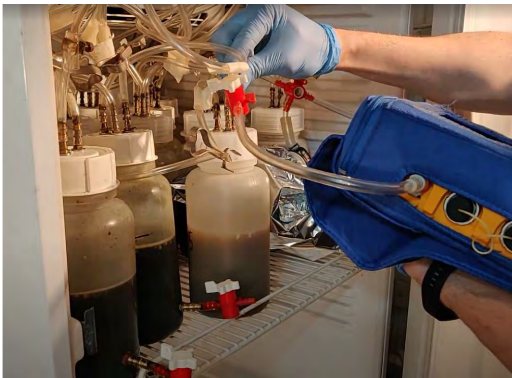
Рис. 2. Измерение состава биогаза непосредственно в биореакторе
