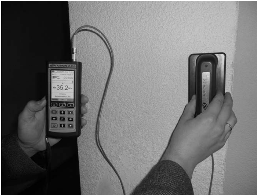
Рисунок 2.1 – Определение толщины защитного слоя бетона, расположения (проекции) арматуры на поверхности бетона и диаметра арматуры в диапазоне 3...50 мм классов S240, S500 с помощью прибора ПОИСК-2.6
