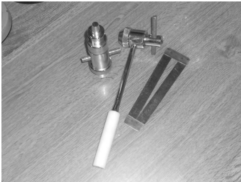
Рисунок 2.2 – Вид на молоток эталонный Кашкарова, масштабную линейку и эталономер для определения марки эталонных стержней
