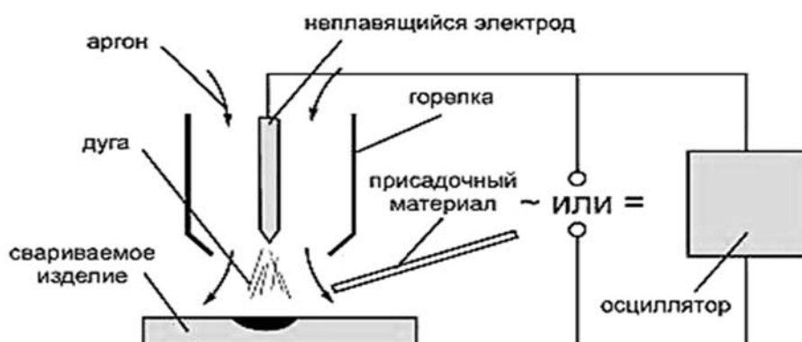
Рисунок 6.2 – Схема процесса сварки в защитных газах неплавящимся электродом
