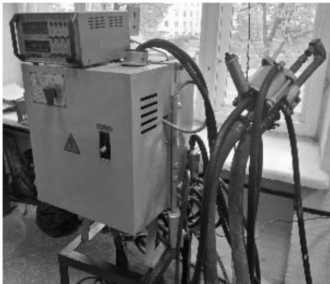
Рисунок 3.1 – Машина КТС подвесная типа МТП-1110
