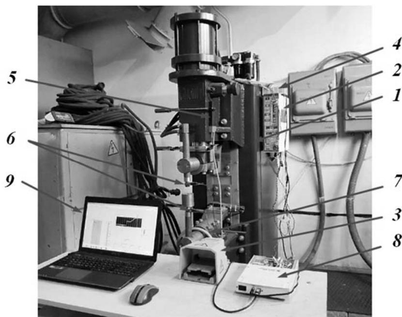
Рисунок 4.1 – Экспериментальная установка для реализации СПУ мощностью тепловложения при контактной рельефной сварке
