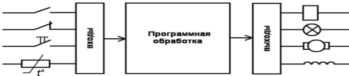
Рисунок 5.1 – Структурная схема ПЛК
