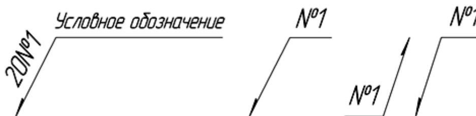
Рисунок 3.12 – Обозначение одинаковых сварных швов
