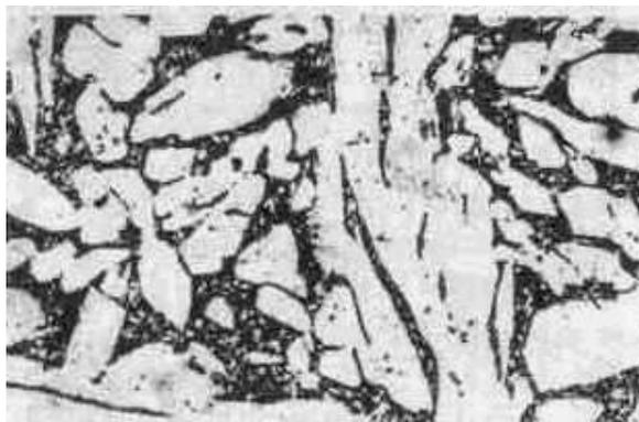
Рисунок 17.5 – Микроструктура литой бронзы БрА10
