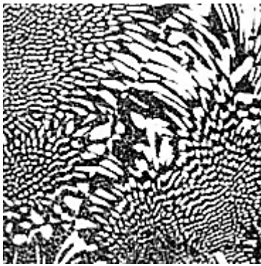
Рисунок 1.2 – Микроструктура эвтектики системы Cu–Cu 3 P (x500)
