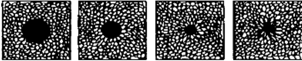
Рисунок 8.4 – Залечивание поры в режиме вязкого течения
