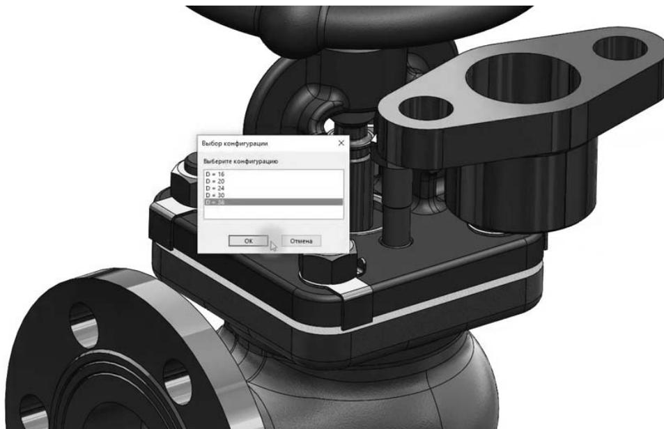
Рисунок 2.6 – Иллюстрация добавления детали в сборку
