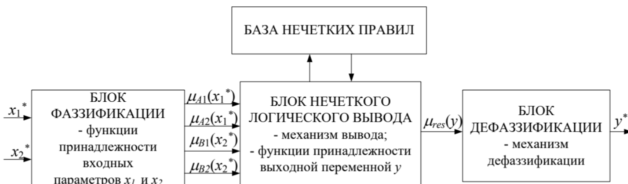
Рисунок 4.1 – Блочная структура модуля нечеткого управления
