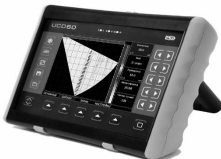
Рисунок 7.1 – Внешний вид ультразвукового дефектоскопа УСД-60ФР
