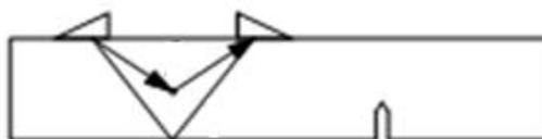
Рисунок 8.7 – Положение преобразователей продольной волны над цилиндрическим отражателем
