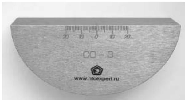
Рисунок 2.3 – Стандартный образец СО-3
