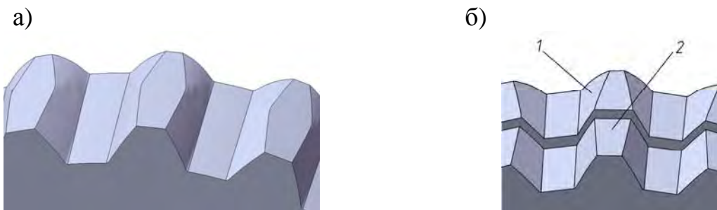
а – компьютерная модель поверхности теоретического зуба сателлита; б – разделенный на две части зуб; 1 – часть поверхности, имеющая сложную пространственно-модифицированную форму; 2 – часть поверхности, представляющая собой эвольвентную коническую поверхность с малым углом конуса
