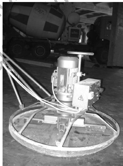
Рисунок 15 – Общий вид прецессионного мотор-редуктора (а) и фотография (б) заглаживающей машины СО–170 со встроенным в ее конструкцию прецессионным редуктором
