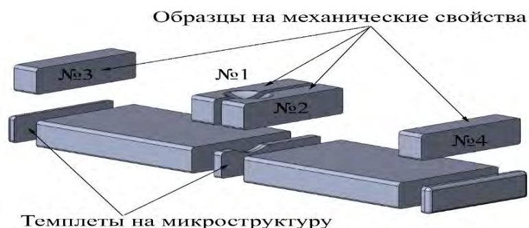
Рис. 2. Схема изготовления темплетов из объема отливки
