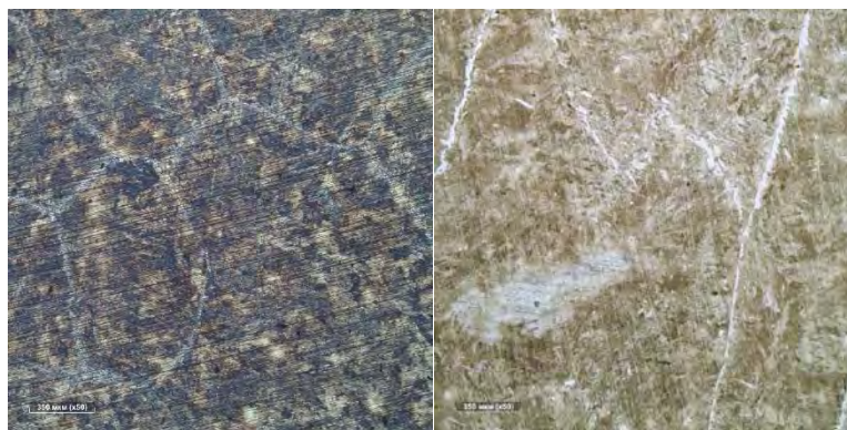
Рис. 6. Микроструктура стали 45 из периферийной пристеночной области верхняя часть (x50)
