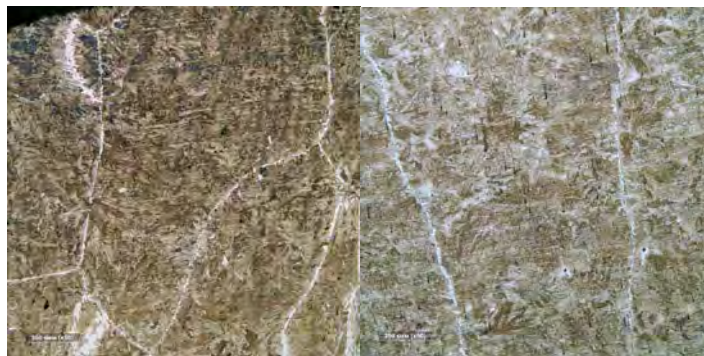
Рис. 3. Микроструктура центрального темплета, извлеченного из области отливки, прилегающей к стенке металлической формы (x50)
