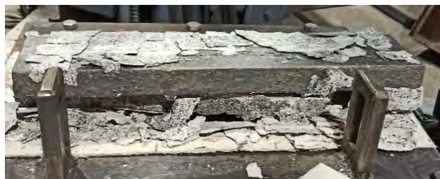
Рис. 1. Фото отливки после извлечения из металлической формы
