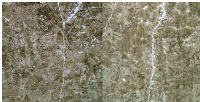
Рис. 5. Микроструктура стали 45 из периферийной пристеночной области нижней части отливки (x50)
