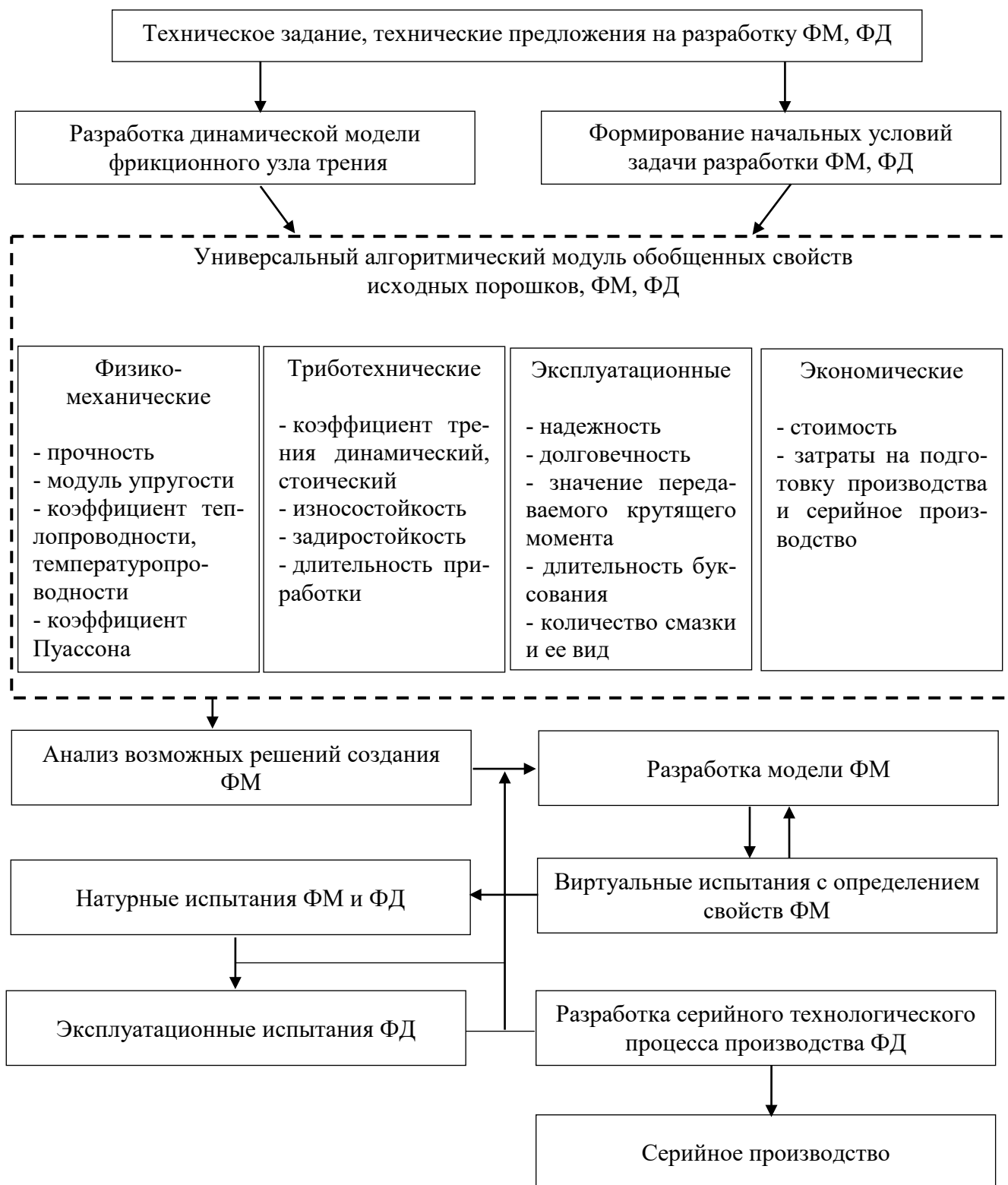
Рис. 1. Алгоритм реализации последовательности действий по разработке ФМ и выпуску ФД
