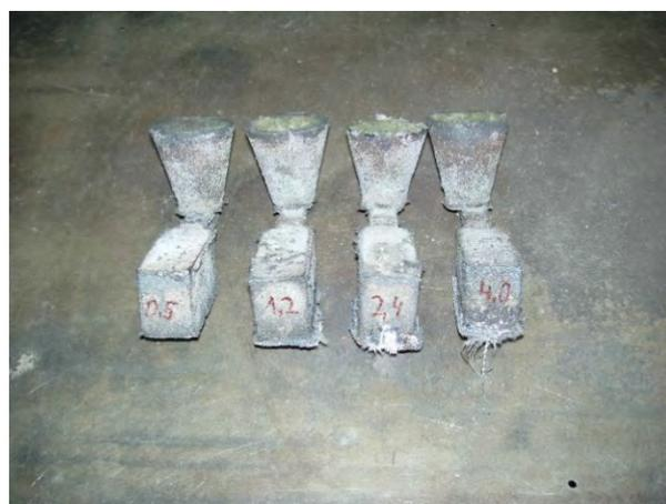
Рис. 2. Образцы, отлитые на свинцовые пластины различной толщины
