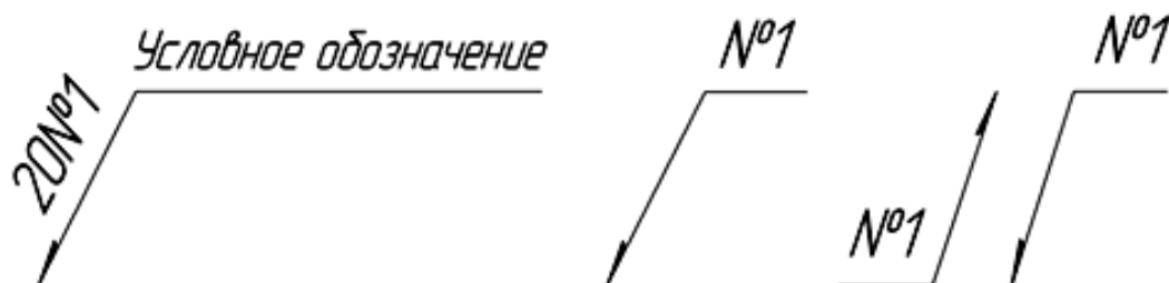
Рисунок 1.7 – Обозначение одинаковых сварных швов
