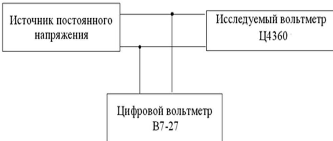
Рисунок 1.1 – Схема для исследования погрешностей вольтметра
