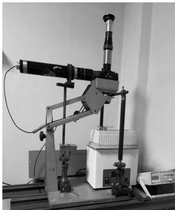
Рис. 1. Принципиальная схема установки (а) и внешний вид макета (б): 1 – зеркало; 2 – опорное кольцо; 3 – кольцо из мягкой резины; 4 – лазер; 5 – пластина светоделительная; 6 – диафрагма; 7 – фотоприемник; 8 – образец; 9 – вентилятор; 10 – водяная баня
