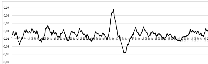
Рис. 2. Сигнал от дефекта – разрыв одной проволоки
