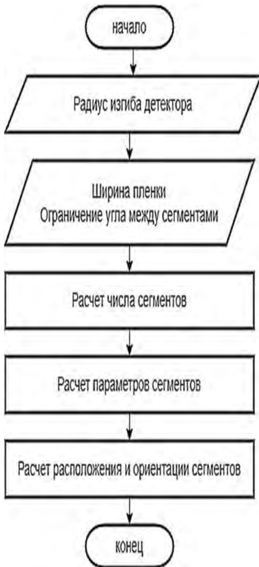
Рис. 1. Алгоритм пересчета геометрии модели детектора
