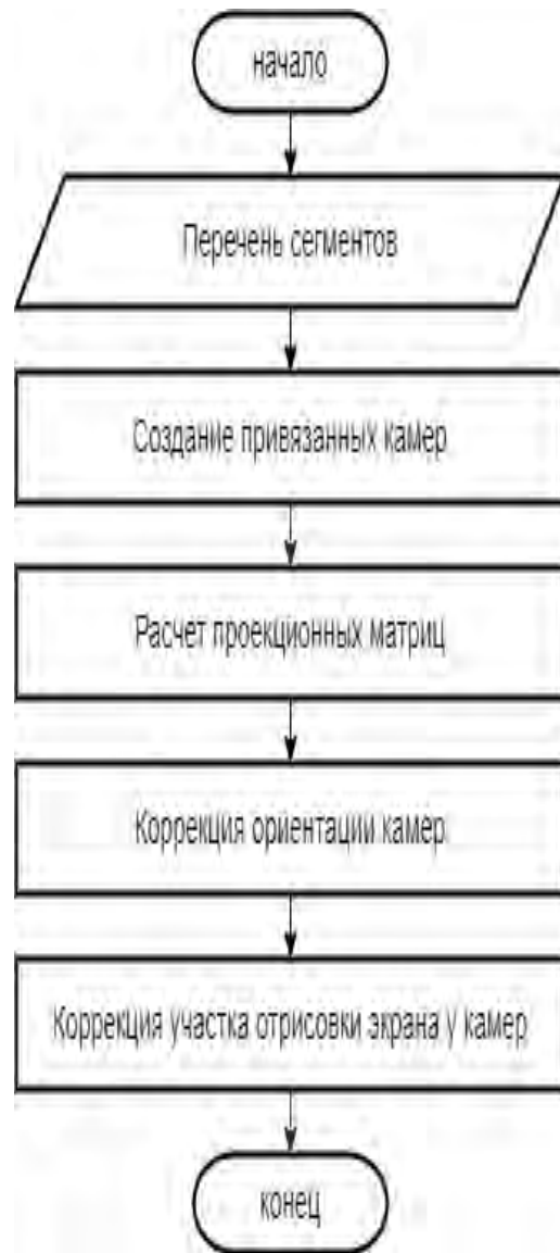
Рис. 2. Алгоритм пересчета параметров проецирования изображения
