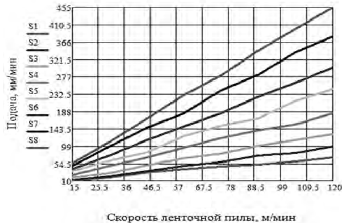
Рис. 2. График зависимости подачи от скорости ленточной пилы
